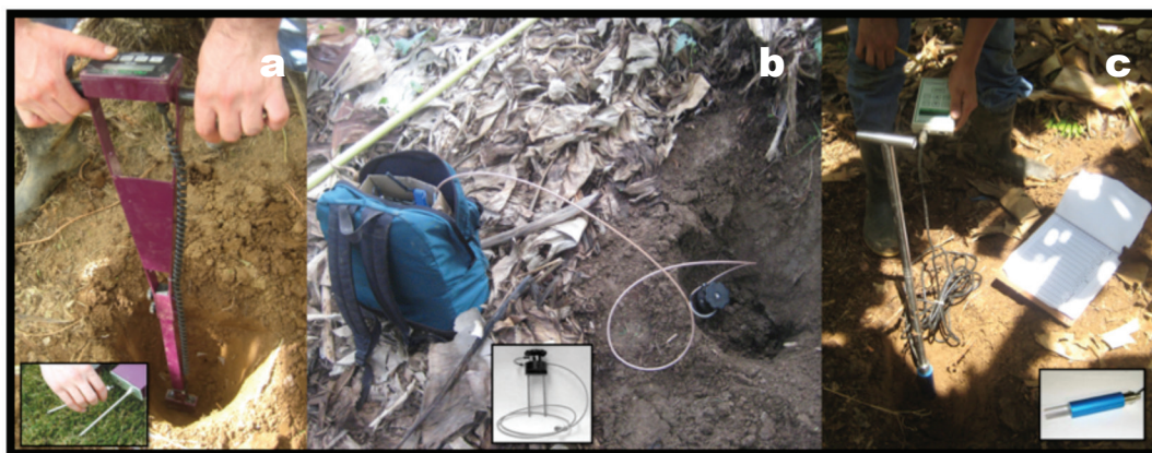
Fig. 2. TDR utilizados para determinación del contenido de humedad volumétrica in situ, a) Opti Science, b) Soil Moisture MiniTrase c) ICT.
