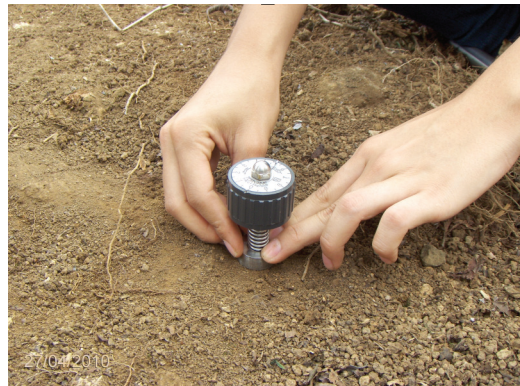
Fig. 3. Representación de la determinación del corte tangencial con una cuchilla de torsión “Torvane” sobre la superficie de un suelo cultivado con café en Juan Viñas, Costa Rica.
