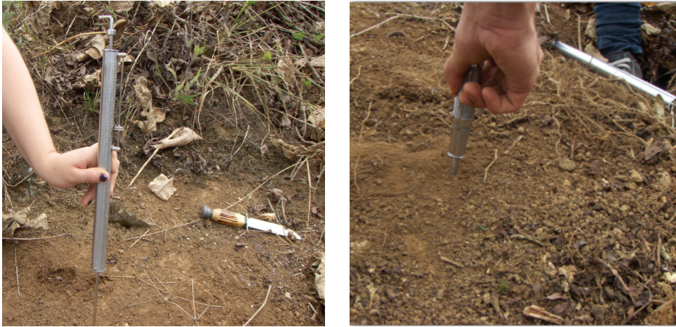
Fig. 2. Representación de la determinación de la resistencia a la penetración utilizando los penetrómetros “Chatillón” y “soil test” en un suelo cultivado con café en Juan Viñas, Costa Rica.
